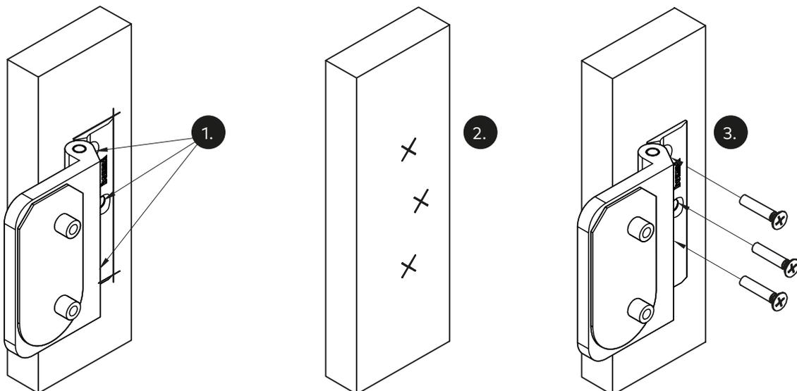
1. Beschlag an die Markierungen halten und alle Bohrungen markieren.
